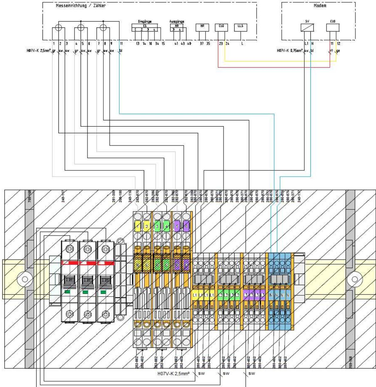
Sicherungsautomaten Z 6A / 25kA
